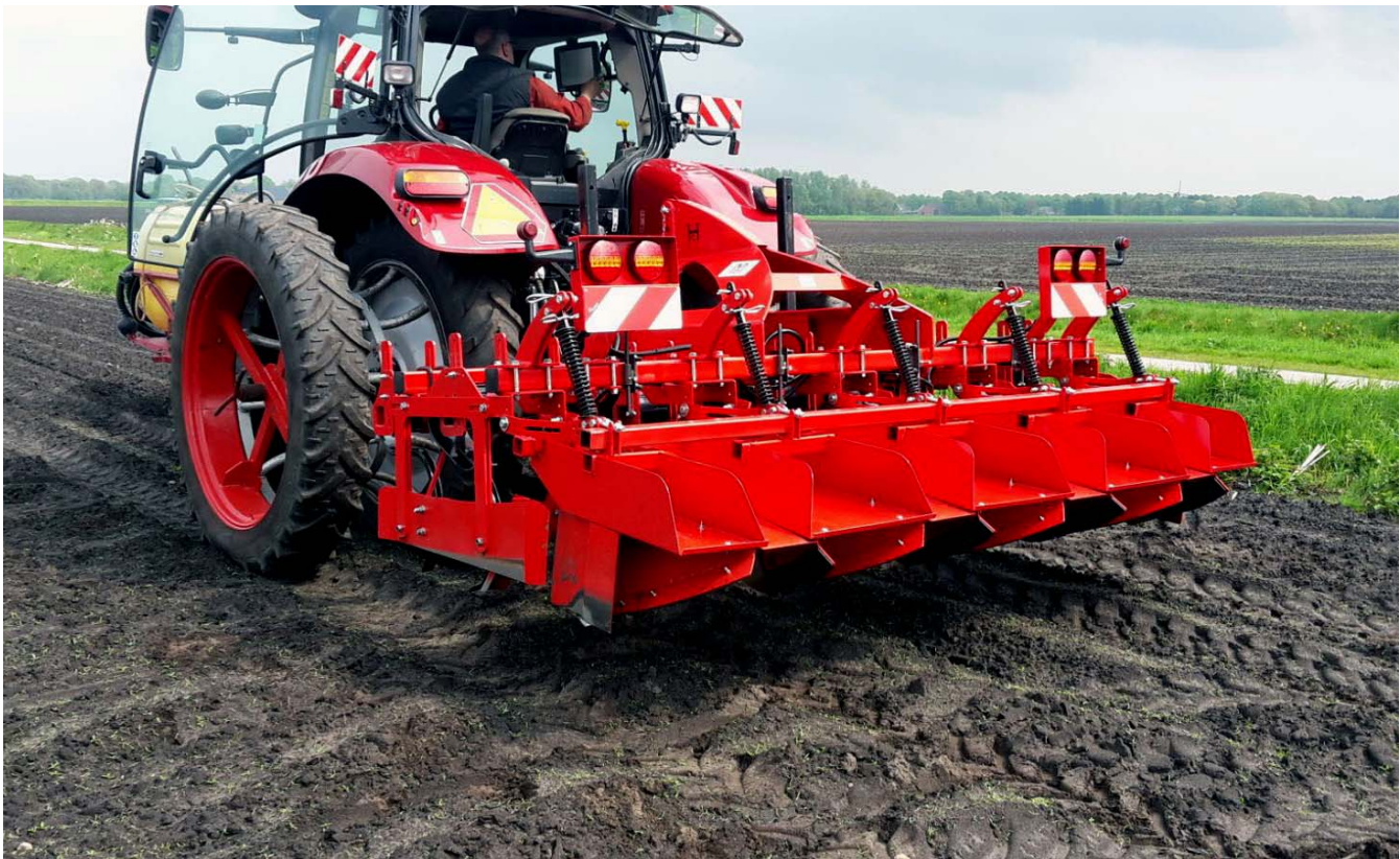
De nieuwe machine voor de aardappelteelt kan tegeliktijd vier ruggen vormen en op de ruggen herbiciden spuiten
