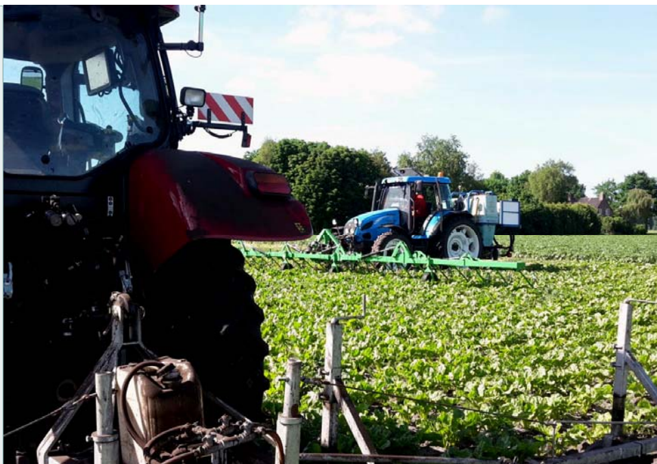
Rijenspuit aan het werk in een veld met tamelijk grote suikerbieten
