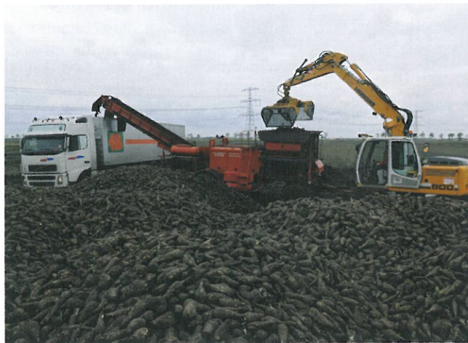
Laden van cichorei over een aangepaste aardappelschoner. De machine is vooral geschikt voor gebruik op lichte grond.
